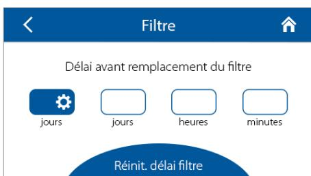
Réglage de la minuterie de maintenance du filtre : à l'expiration d'une période prédéfinie (70-365 jours), la page principale affichera une alerte de remplacement du filtre tandis que la fenêtre Alarms affichera les informations correspondantes sur le remplacement nécessaire du filtre.
